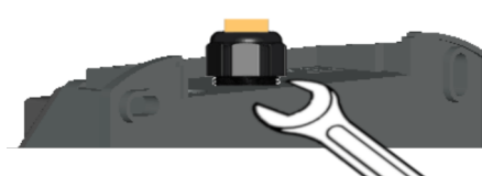
Fig. 6-15: Serrare il passacavo a vite dal retro
