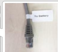
**F** L'altra estremità del cavo "Alla batteria" deve essere collegata alla porta CAN sul lato superiore della batteria LG.
